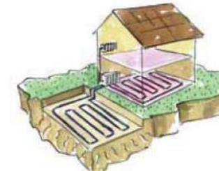
Capteurs horizontaux enterrés à environ un mètre
